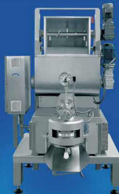
Mod. PC 300 VRT con IM 80 Pressa da 300/350 KG/H con alimentazione per produzione in continuo tramite vasca ribaltabile (possibile alimentazione con impastatrice continua tipo Grim). Extruder for 300/350 Kg/h feed, for continuously production, by Tip-up mixer (it is possible to feed the extruder by continuous mixer, Grim type.)
