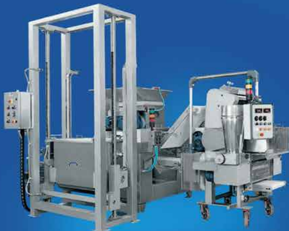
Linea per la produzione di cappelletti, composta da: impastatrice Ribaltabile IR 130 Cilindro automatico A540F+ Cappellettrice / Raviolatrice RC540. La linea può essere abbinata a linee di pastorizzazione o pre-cottura "CAPPELLETTI" PRODUCTION LINE, consisting of: IR 130 TIP-UP MIXER A540F+ AUTOMATIC CYLINDER RC540 "CAPPELLETTI" / RAVIOLI MACHINE. This production line can be combined with pasteurising or pre-cooking lines.
