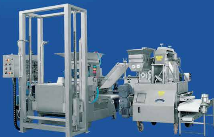
Linea per la produzione di ravioli a doppia sfoglia, composta da: impastatrice ribaltabile IR 130; Cilindro automatico A540F2 a doppia uscita. Raviolatrice a Doppia sfoglia RSA540. La linea può essere abbinata a linee di pastorizzazione o pre-cottura. DOUBLE-PASTRY RAVIOLI PRODUCTION LINE, consisting of: IR 130 TIP-UP MIXER A540F2 AUTOMATIC CYLINDER - provided with double outlet, RSA540 DOUBLE-PASTRY RAVIOLI MACHINE. This production line can be combined with pasteurising or pre-cooking lines.
